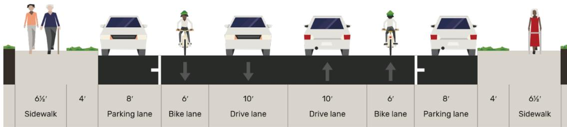
**FIGURE 31: PREFERRED LOCAL STREET TYPICAL CROSS-SECTION – PARKING ONE SIDE ONLY**
