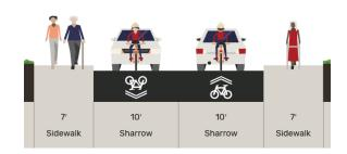
FIGURE 35: ACCEPTABLE LOCAL STREET TYPICAL CROSS-SECTION - PARKING ONE SIDE ONLY
