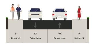
FIGURE 37: ACCEPTABLE LOCAL STREET TYPICAL CROSS-SECTION - SHARED STREET
