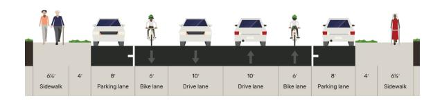
FIGURE 31: PREFERRED LOCAL STREET TYPICAL CROSS-SECTION - PARKING ONE SIDE ONLY
